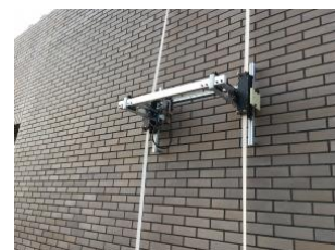
外壁点検昇降用ロボット 『NOBORIN』
