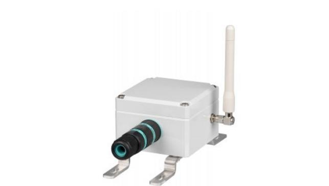
世界で初めて CD-R を開発した太陽誘電は、その光学技術を応用し、水面の反射電波を正確に捉えて水位を計測できる『水害監視システムソリューション』を開発。河川の堤防決壊などが引き起こす洪水や内水氾濫の被害を最小限に抑え、住民の生命と財産を守るためのソリューションを提案する。
