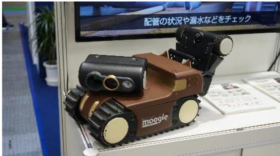
大和ハウス工業は狭小空間点検用ロボット「moogle evo（モーグル エヴォ）」を展示。住宅の定期点検や現況検査、耐震、シロアリ診断などを遠隔操作で行える「moogle」に、橋梁や高速道路などのインフラ点検に必要な機能を追加した新モデルだ。
