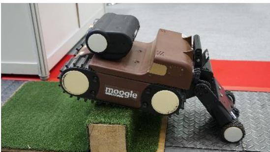
ブースでは実機デモンストレーションを行っており、カメラの映像や段差を乗り越える様子を確認することができる。すべて無線による遠隔操作が可能となっている。
